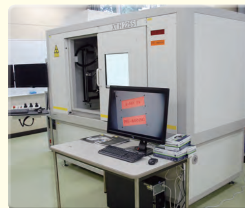
▲X線／CTシステム（3D計測）「XTH225ST」。小型～中型鋳物が対象で、内部構造の鮮明な画像が得られるのが特徴
