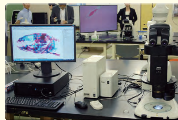
▲蛍光実体顕微鏡「SMZ25」。ズーム比は1:25で、1600万画素を超える高精細カメラも搭載
